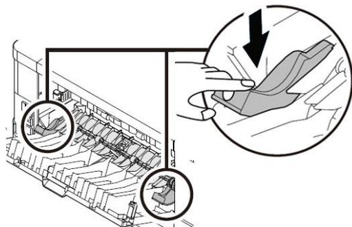
**3** Нажмите на рычаги, расположенные справа и слева от тракта прохождения бумаги до их фиксации в нижнем положении.
