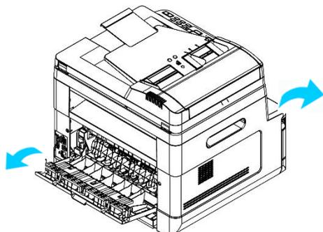
2. Откиньте вниз выходную направляющую узла термозакрепления.
