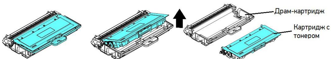
**5** Протрите поверхность фотобарабана чистой и мягкой тканью.
