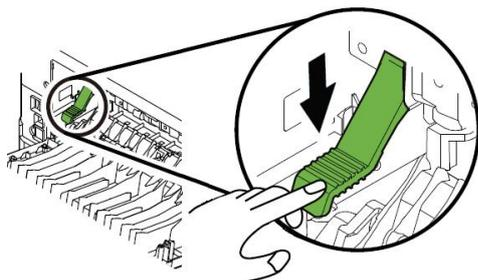
**4** Снимите две фиксирующие пластины с обеих сторон от направляющих бумаги.
