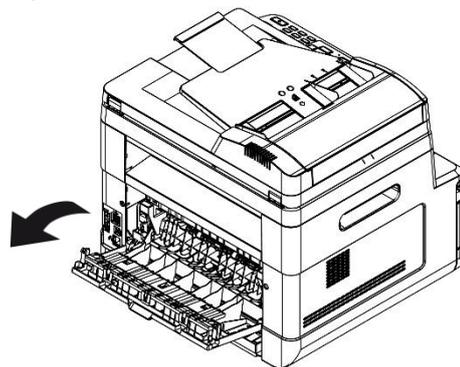
Узел двусторонней печати: вытащите узел двусторонней печати, находящийся под задней крышкой, из основного корпуса.
